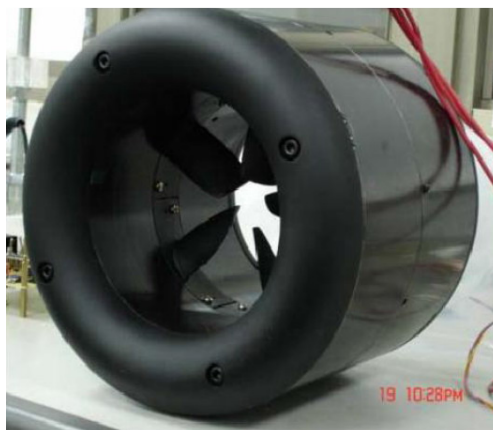
Figura 3 - Propulsor integrado ao duto. Retirada de [25]
