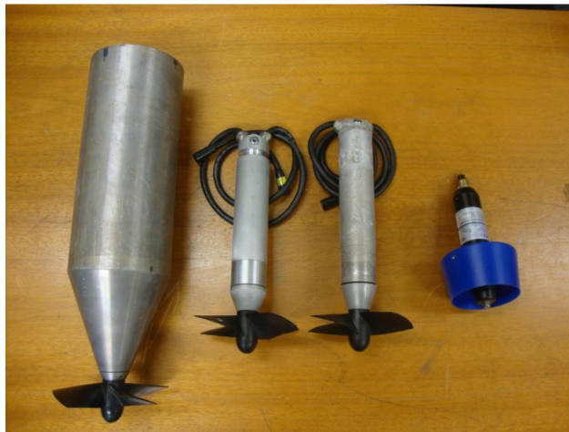
Figura 8 - Comparação entre os propulsores desenvolvidos no LVNT e o Tecnadyne 300.
