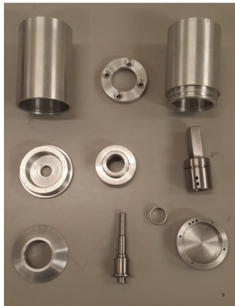
Figura 21 - Peças da estrutura mecânica fabricadas
